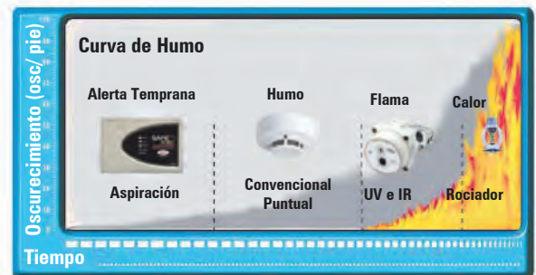
Oscurecimiento (osc/ pie). Porcentaje de disminución de luz por pie, debido a humo, suciedad, polvo o contaminantes en un ambiente
